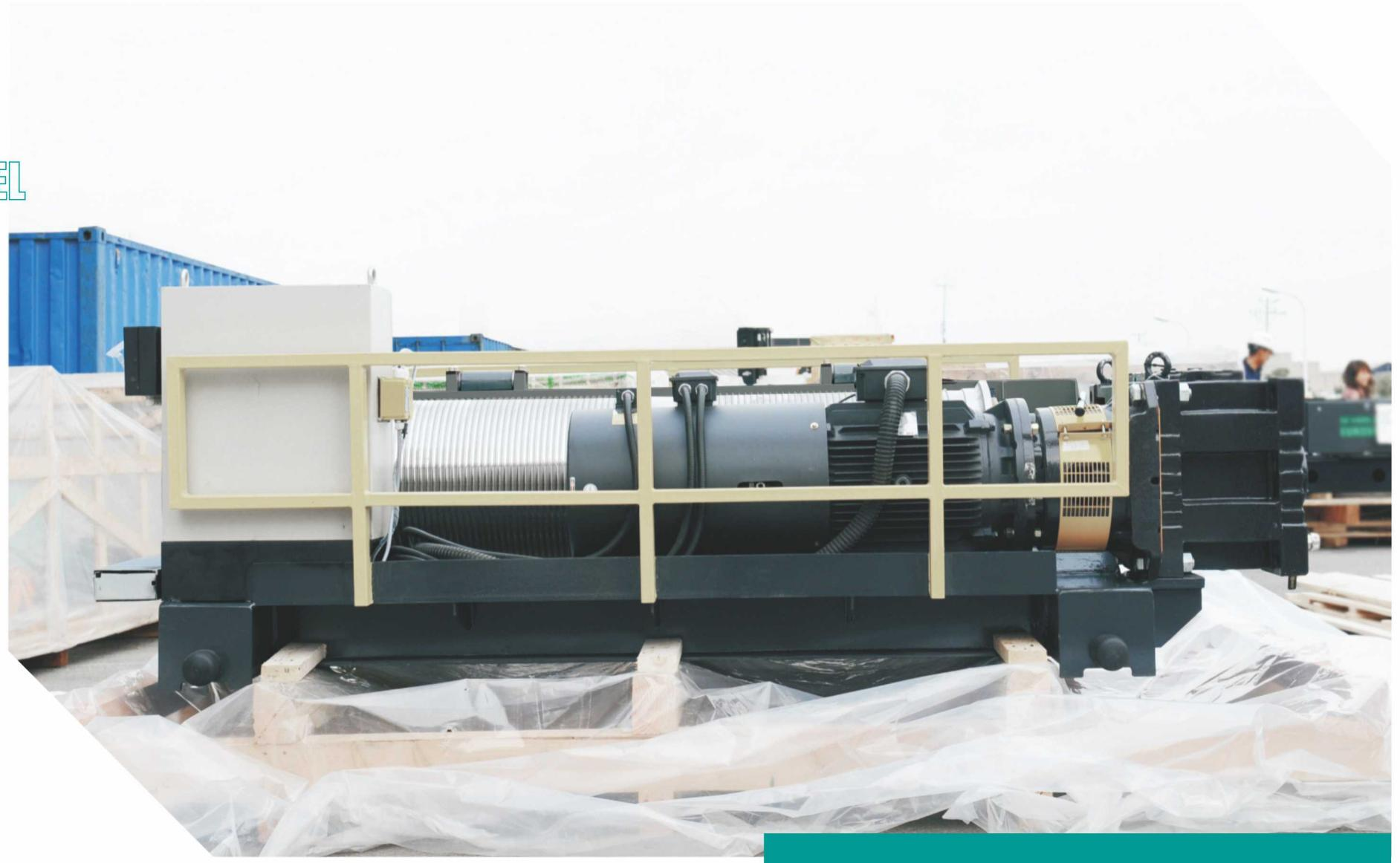
La caja de engranajes de dientes duros está diseñada para adaptarse a condiciones de trabajo frecuentes y pesadas. El eje de baja velocidad está conectado directamente con el tambor y los engranajes de todos los niveles están endureciendo engranajes helicoidales tratados. La lubricación de larga duración se realiza mediante un baño de aceite para garantizar una mayor resistencia a la abrasión y un funcionamiento silencioso.
